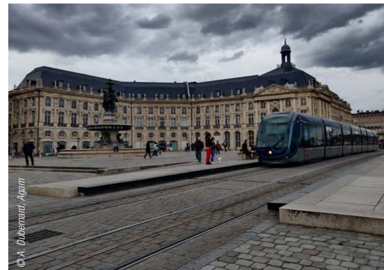
À Bordeaux, le tramway circule sans caténaire. La station est intégrée à la Place de la Bourse, avec des quais et des voies qui reprennent le pavage de la Place, et sans le moindre mobilier urbain.
